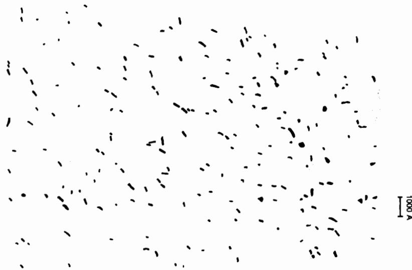
**Fig 5:** Observation de l'organisation du gel de laponite de fraction solide égale à 3% et de force ionique fixée à  $10^{-2}$  mol/l. Cette image binaire a été réalisée à partir d'une observation par MET après cryofracture et répliques de platine.
