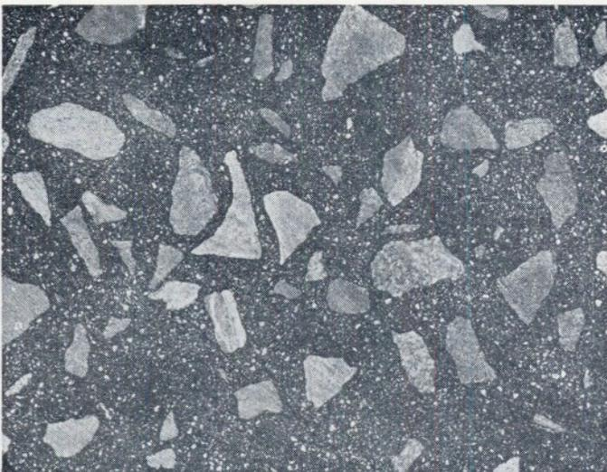
C — Enrobé dense « Rolled Asphalt »
