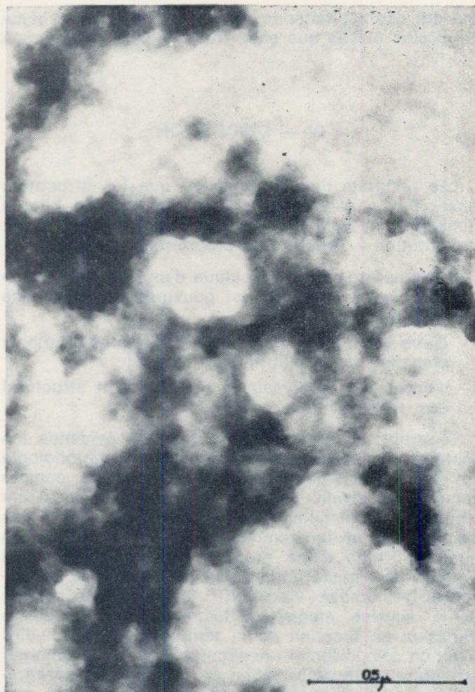
Fig. 13. — Structure d'un bitume gel après extraction à l'heptane chaud
