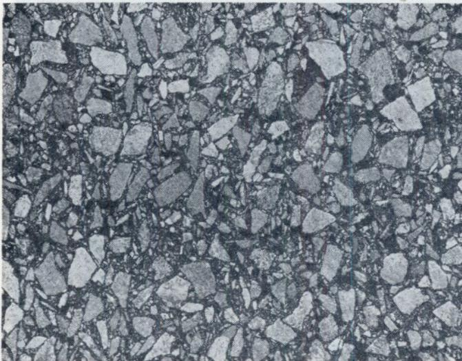
A — Béton bitumineux 0/10 semi-grenu
