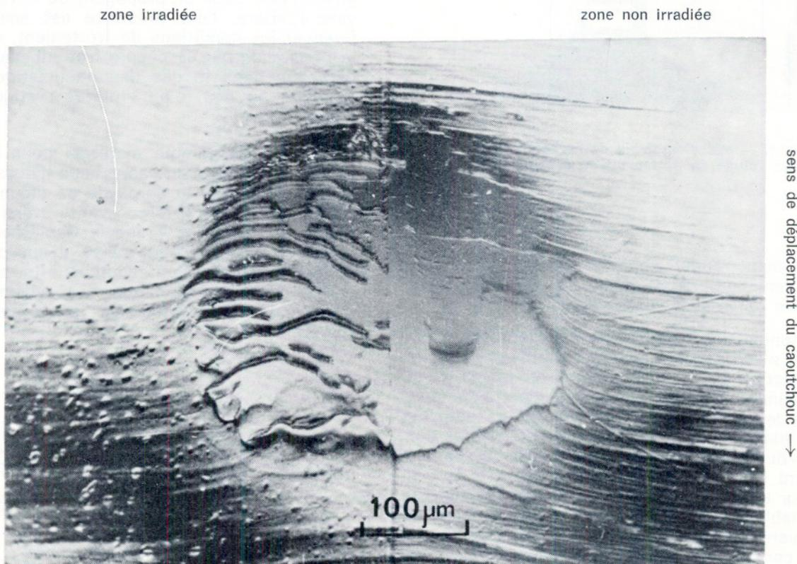
Fig. 4. — Propagation d'ondes de Schallamach dans l'aire de contact entre une bille de verre et une surface de caoutchouc dont la moitié gauche a été irradiée aux U.V.
