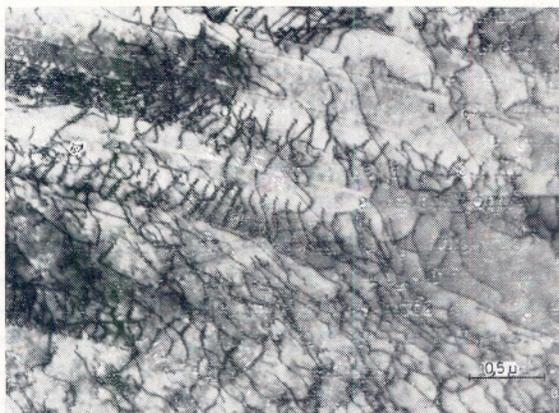
Fig. 8. — Echevaux de dislocations au fond d'une trace de frottement sur du laiton  $\alpha$
