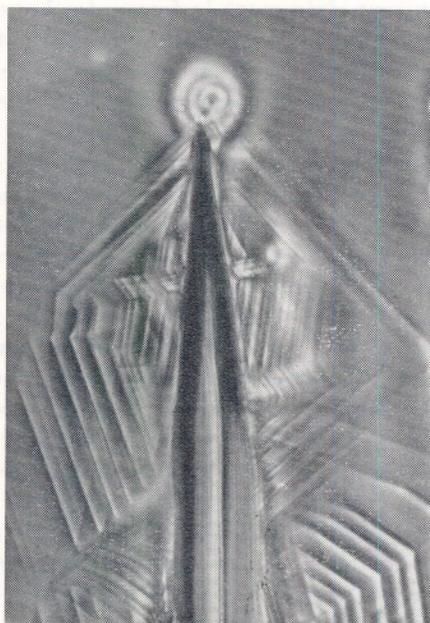
**Fig. 8.** — Trace laissées par un diamant après un essai de rayure sur un alliage Ni-Cr.
