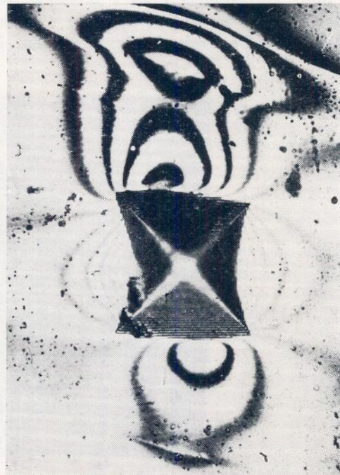
Fig. 13. — Microphotographies de deux empreintes VICKERS faites sur un monocrystal de bismuth. Illustration des clichés de la fig. 12. Grossissement :  $G = 250 \times$ .
