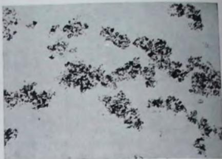
Fig. 18. — Suspension de kaolin floculée
