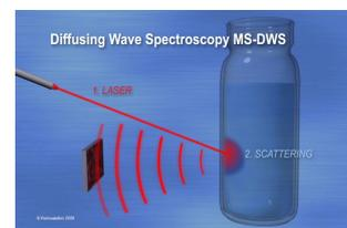
Figure 1. Principe de la MS-DWS
