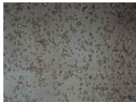
Fig.2b : photographie microscopique de l'émulsion de 8,6\mu\text{m} de diamètre
