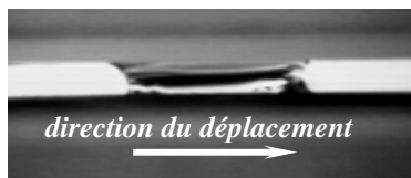
Fig. 4 : Allure du profil du pont liquide au cours du cisaillement (entrefer = 2mm)
