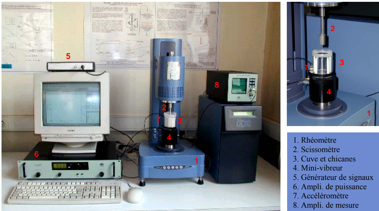
Figure 1 : Rhéomètre à poudre et cellule de mesure.
