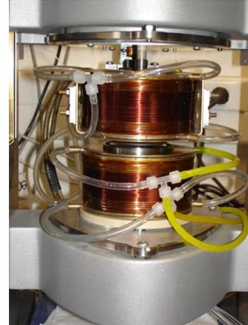
Figure 1 : Dispositif de magnéto-rhéologie. Les deux bobines indépendantes l'une de l'autre sont placées de part et d'autre de la géométrie cône/plan.
