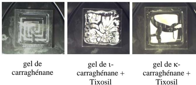
Figure 8 : Photographie de gels de composition variable après séchage.
