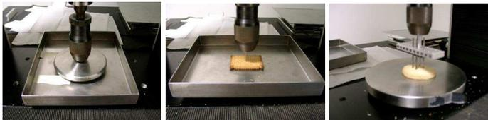
Figure 2 : Les trois types de cellules de compression utilisées : plateau, indenteur ou poinçon, multi-indentation.
