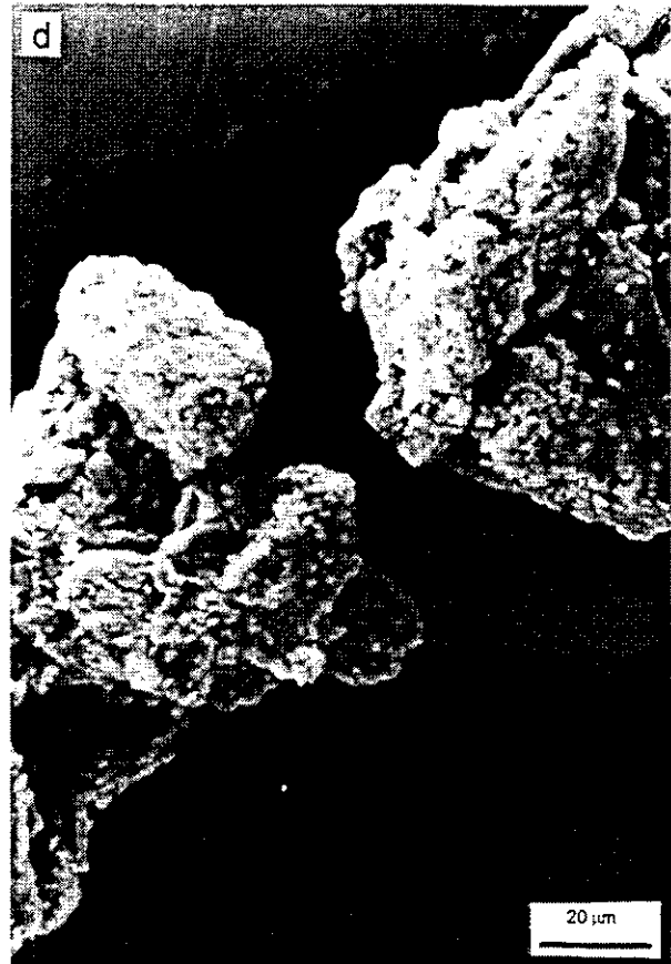
Figure 2 Observation au MEB du mélange à sec (a) et des agglomérats obtenus par granulation sèche (b), extrusion-sphéronisation (c) et granulation humide séquentielle (d)
